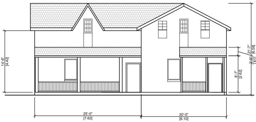
EXISTING FRONT ELEVATION SCALE: 1/8" = 1'-0"
